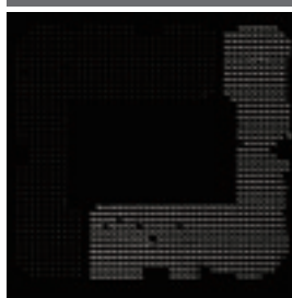
LGA的电极缺陷检查
