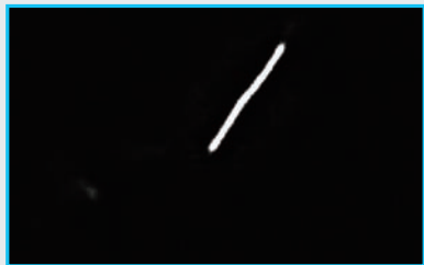
检测图像 只检测到划痕部分
