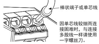
因单芯线较细而连接困难时，与连接多股线一样请使用一字螺丝刀。
