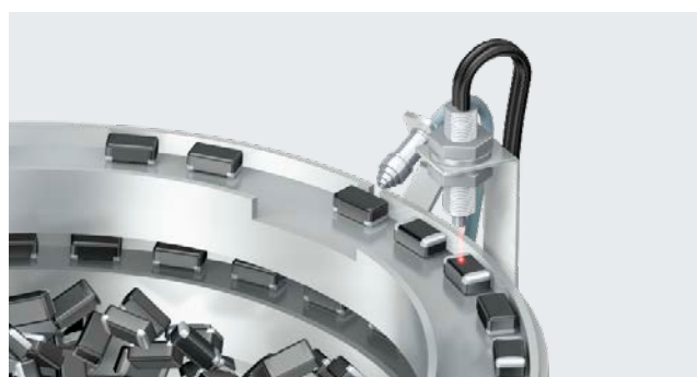
部件正反检测时的吹气输出
