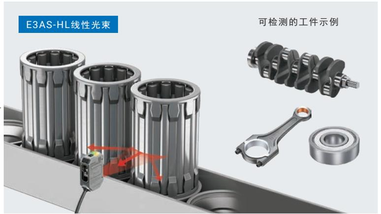
E3AS-HL采用线性光束，由于反射光可从任一面返回传感器，不易受到工件表面形状影响。即使检测的金属工件表面因为油污而带有光泽，也不易受其影响。
