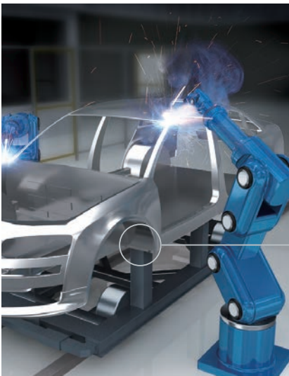
待焊接金属板的到位确认
