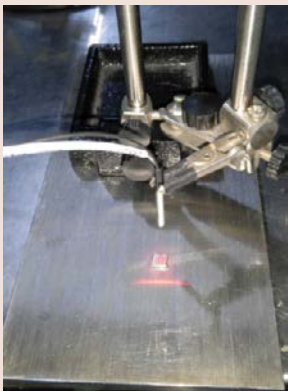
※ 测试条件：检出物 SIZE：① 5X5X5mm，表面拉丝不锈钢；设定距离：20mm；检出背景：不锈钢表面，车削加工，粗糙度 12.5S
