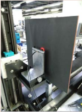
※ 测试条件：检出物 SIZE：① 300X300mm，黑纸；各产品初始阈值条件。
