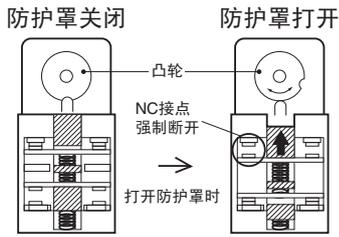
打开防护罩时，与轴杆直接耦合的凸轮通过旋转沿着（垂直）箭头所示的方向压下开关。这个动作会断开接点，停止机器。
