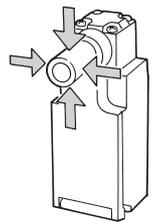
请如下图所示的方式安装悬臂摆杆和门，保证开门或关门时开关轴杆和头部不会承受机械压力。
