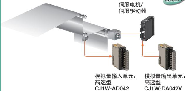
通过直接转换实现CJ2 CPU单元的高速模拟量输入。
