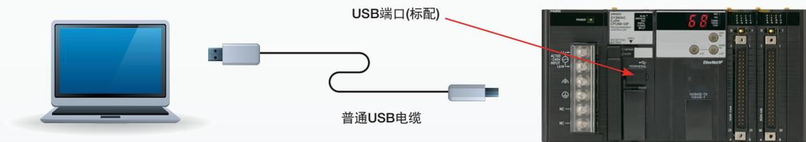
还可通过USB访问EtherNet/IP上的CJ2 CPU单元，不需要路由器电缆。
