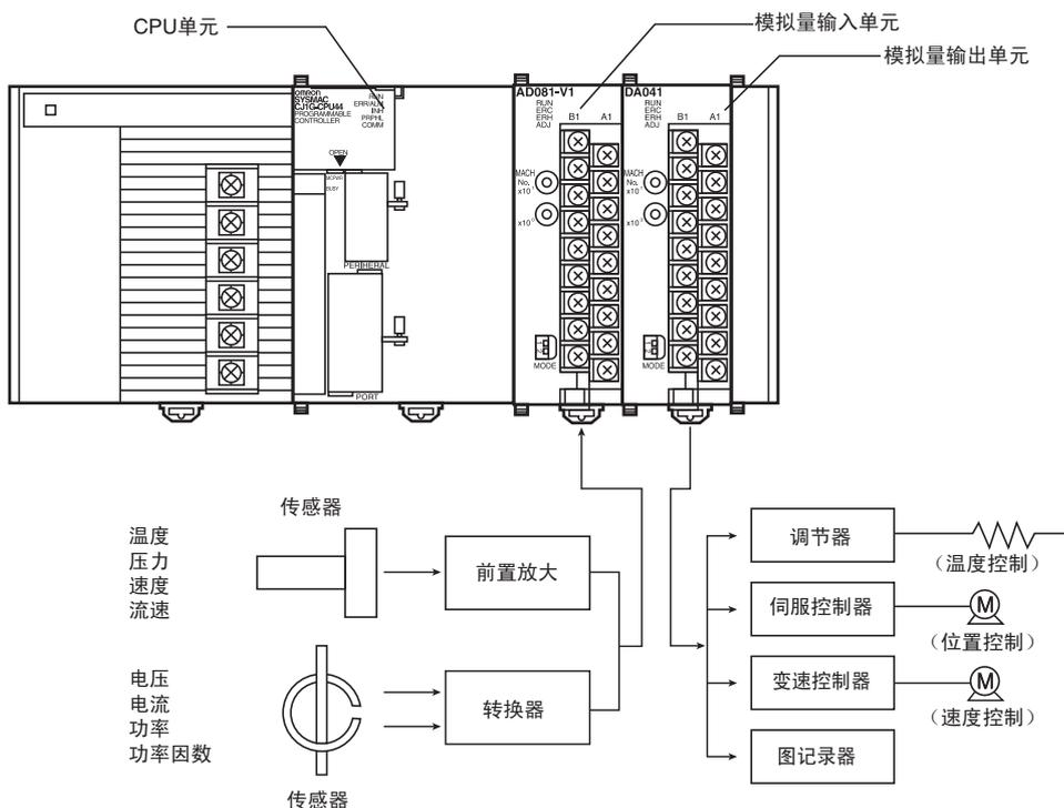
注：上图是CJ1W-AD081-V1模拟量输入单元和CJ1W-DA041模拟量输出单元的安装示例。
