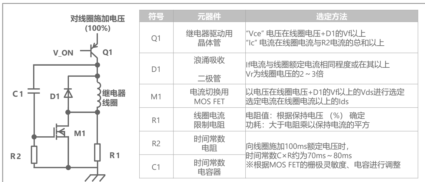
[ 图14：推荐保持电压CR电路示例、周边元器件的选定方法 ]
