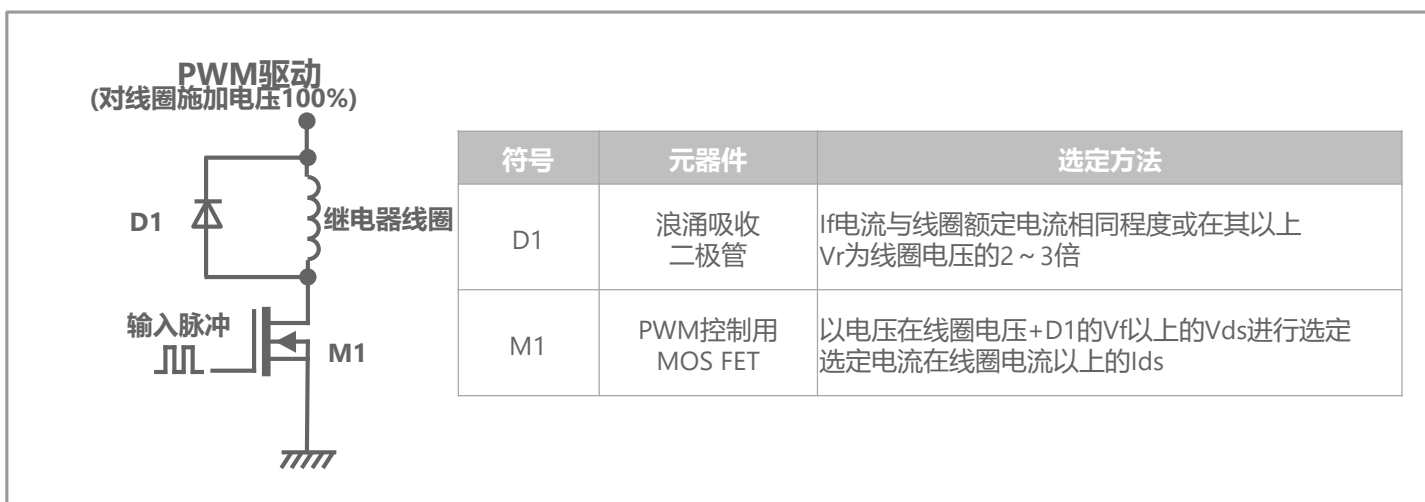
[ 图20：推荐PWM控制电路示例、周边元器件的选定方法 ]
