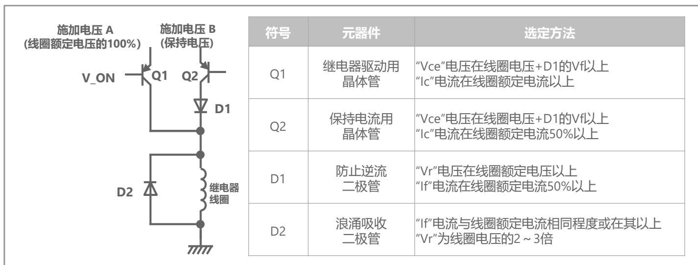
[ 图18：基于开关的推荐保持电压电路示例、周边元器件的选定方法 ]
