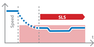
Safely-Limited Speed (SLS) 控制马达速度，使其不超过指定速度。
