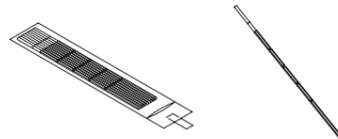
(2) 传感器控制器侧光纤接口端面的清扫
