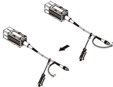
(2) 将光纤电缆和校准 ROM 连接于传感器控制器。光纤接口凸起部与传感器控制器的光纤接合器沟槽部相互吻合地安装光纤电缆。光纤接合器的沟槽部上对准光纤接口凸起部，边推进边将螺丝部右转。
