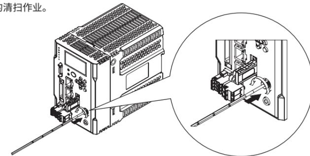
(3) 传感器探头侧光纤接口端面的清扫
