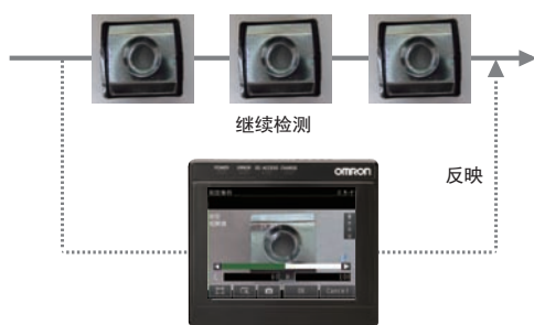
利用触摸式操作器调整判定条件
